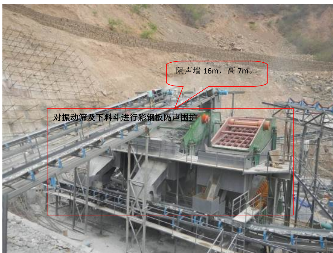
图 6.7-13 一筛车间隔声屏示意图
