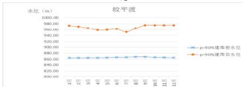
图 5.1-23 枯水年建库前后皎平渡断面水位对比
