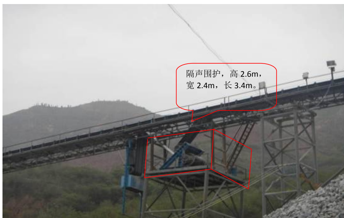
图 6.7-11 棒磨机车间隔声屏示意图
