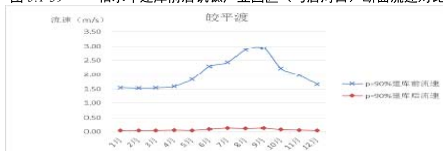
图 5.1-41 枯水年建库前后皎平渡断面流速对比
