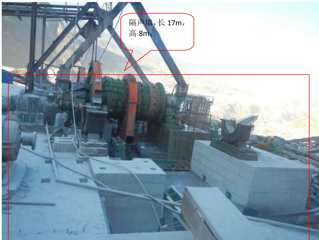
图 6.7-10 中细碎车间隔声防护棚示意图
