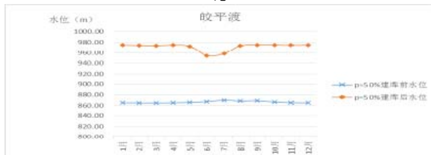
图 5.1-17 平水年建库前后皎平渡断面水位对比
