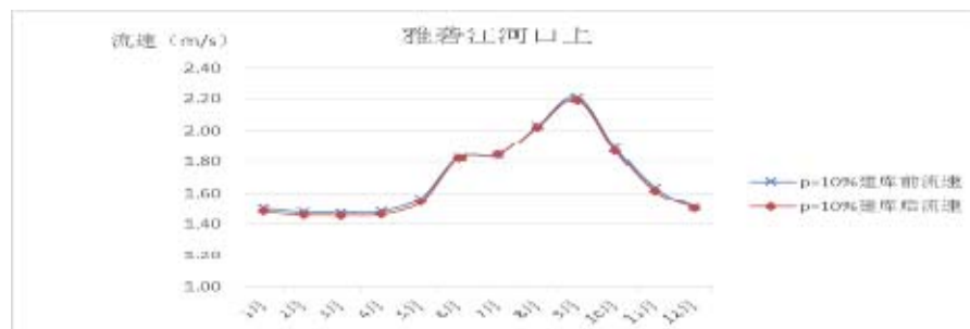
图 5.1-25 丰水年建库前后雅砻江河口上断面流速对比
